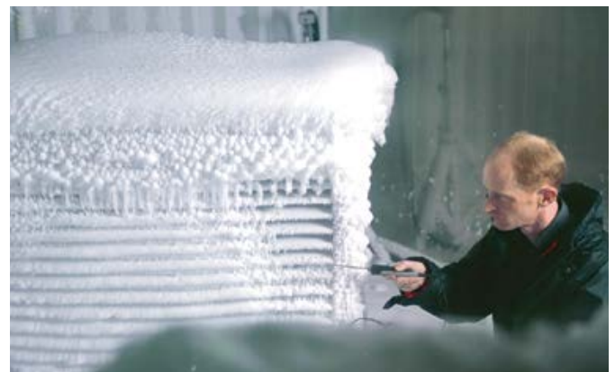
Komory klimatyczne symulują wszystkie potencjalne warunki eksploatacji
